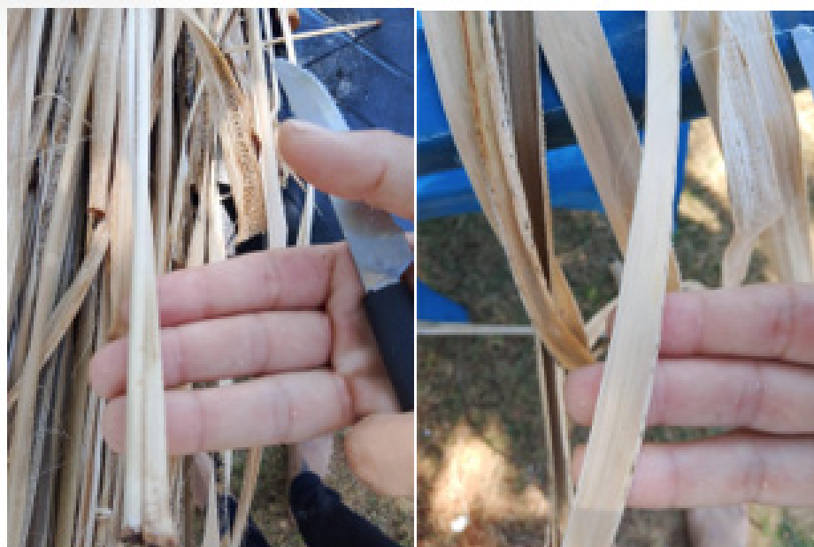
Figura 7 – Antes e depois do processo de desenvergar a fibra
